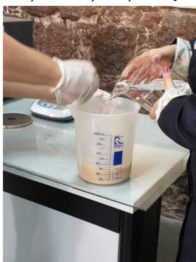
Figura 4 - Mistura dos reagentes caulim, bentonita, EDTA, NaHCO 3 e H 2 O
