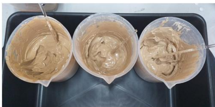
Figura 6 - Amostras prontas com consistência de pasta
