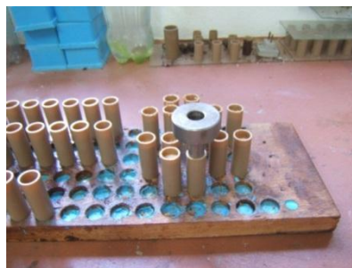
(b) Compactação manual
