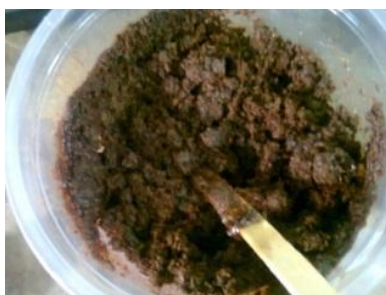
Figura 4 - Mistura manual entre serragem de ipê e resina epóxi
