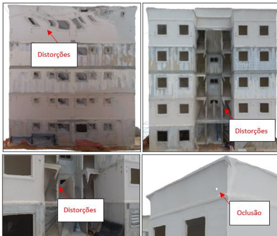
Figura 7 - Inconsistências do modelo gerado pelo software Recap a partir das fotos coletadas pelo drone: representação errônea da aparência e medidas (à esquerda acima), (à direita acima) e (à esquerda abaixo); presença de vazios (à direita abaixo)
