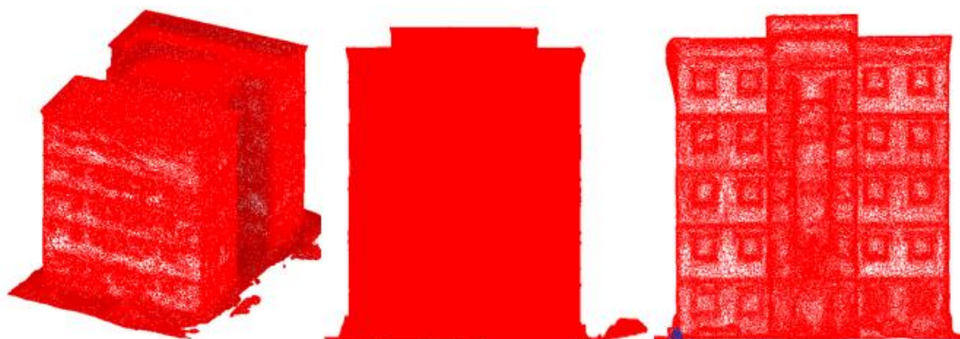
Figura 8 - Nuvem de pontos gerada por fotogrametria e aplicada no software Autodesk Revit: geral (à esquerda), fachada I (ao centro) e fachada II (à direita) da edificação
