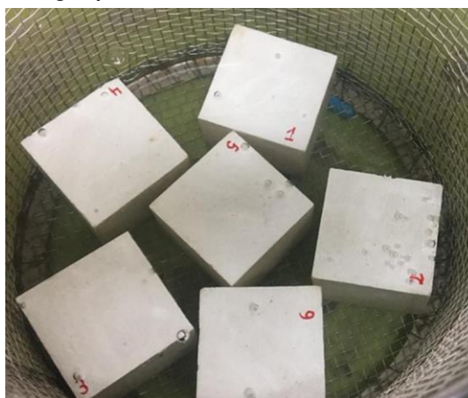
Figura 4 - Ensaio de absorção de água por imersão total
