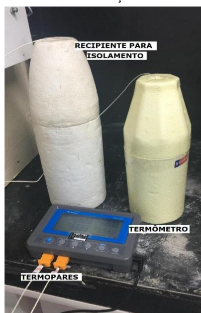
Figura 2 - Ensaio pseudoadiabático de calor de hidratação
