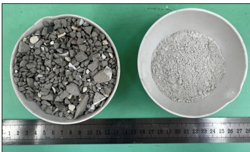
Figura 1 - Resíduos de louça sanitária britado (esquerda) e moído (direita)
