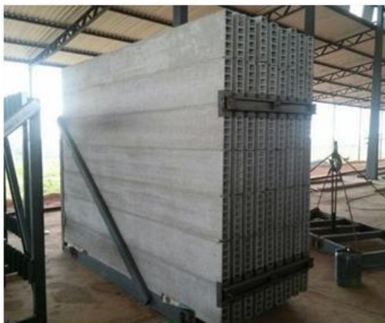
Figura 1 - Perfil pré-moldado com 6 furos
