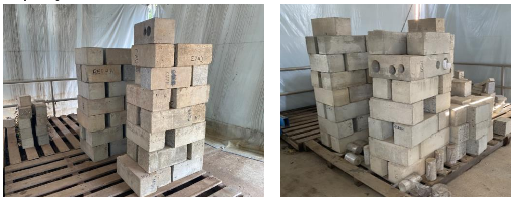
Figura 2 - Corpos de prova de ensaio de carbonatação natural produzidos em 2002 e dispostos em ambiente protegido de chuva
