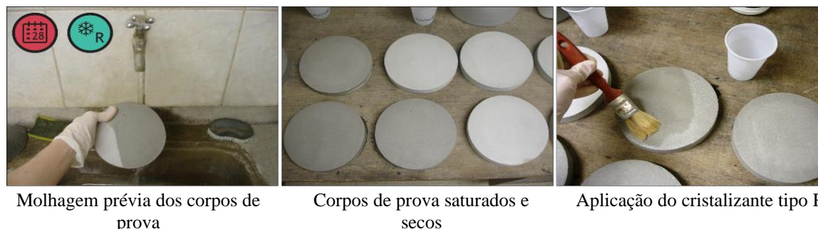
Figura 4 - Aplicação do cristalizante R aos 28 dias
