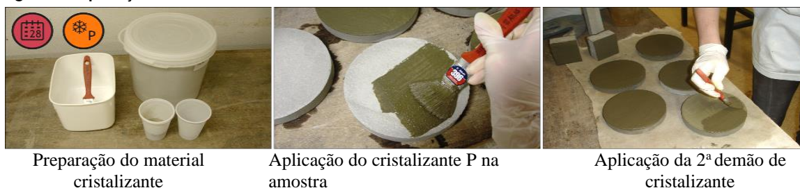
Figura 5 - Aplicação do cristalizante P aos 28 dias
