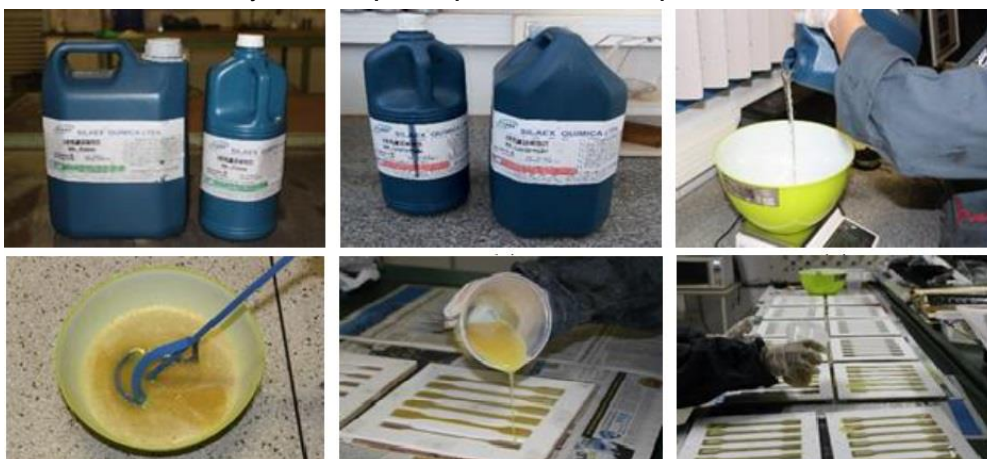
Figura 9 - Processo de fabricação dos corpos de prova de resinas epoxídicas
