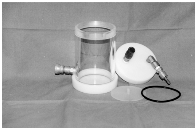
FIGURA 3 – Reservatório de água estéril, limpo e seco, em condições de ser armazenado
