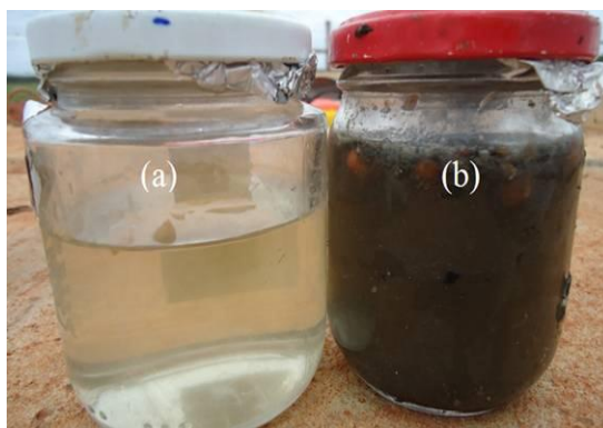
Figura 7. Indicador visual do nível de tratamento obtido na mini-estação. Efluente tratado (a) e efluente sem tratamento (b).
