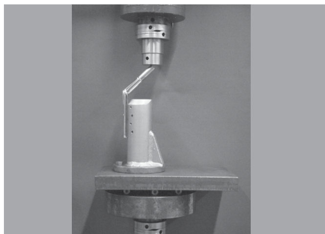
Figura 3. Montagem completa do dispositivo na máquina de ensaio da placa angulada DHS-AF®.
