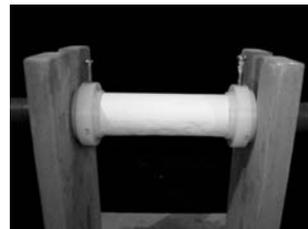
Figura 3 - Molde com CDP (cilindro)
