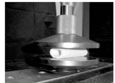
Figura 7 - Ensaio de compressão (cilindros).
