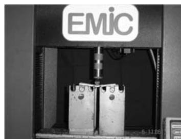
Figura 6 - Ensaio de Flexão em 3 pontos (placas).
