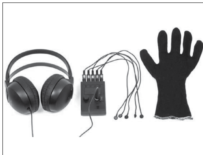
Figura 1. Componentes do modelo da luva sensorial: fones de ouvido, caixa de acondicionamento do circuito e luva de tecido.
