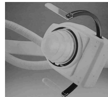
Figura 3 - Bolsa elástica inflável; controla a profundidade do foco das ondas de choque.
