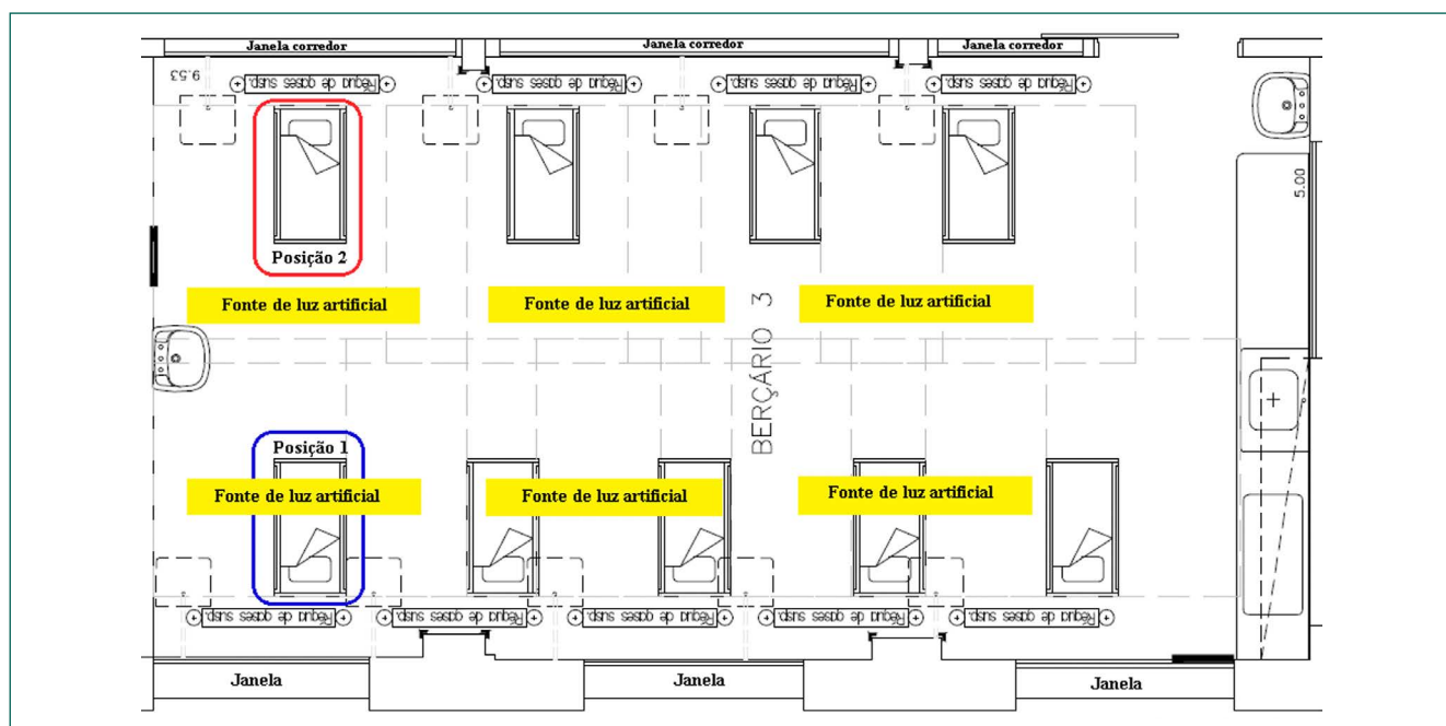
Figura 1. Esquema ilustrativo do posicionamento dos mobiliários segundo a fonte de iluminação da Instituição B
