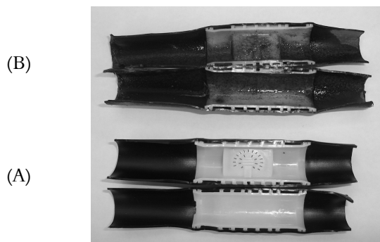
Figura 6. Tubogotejador novo (A) e após 700h de funcionamento (B), com a presença de mucilagem formada pelas ferrobactérias.
