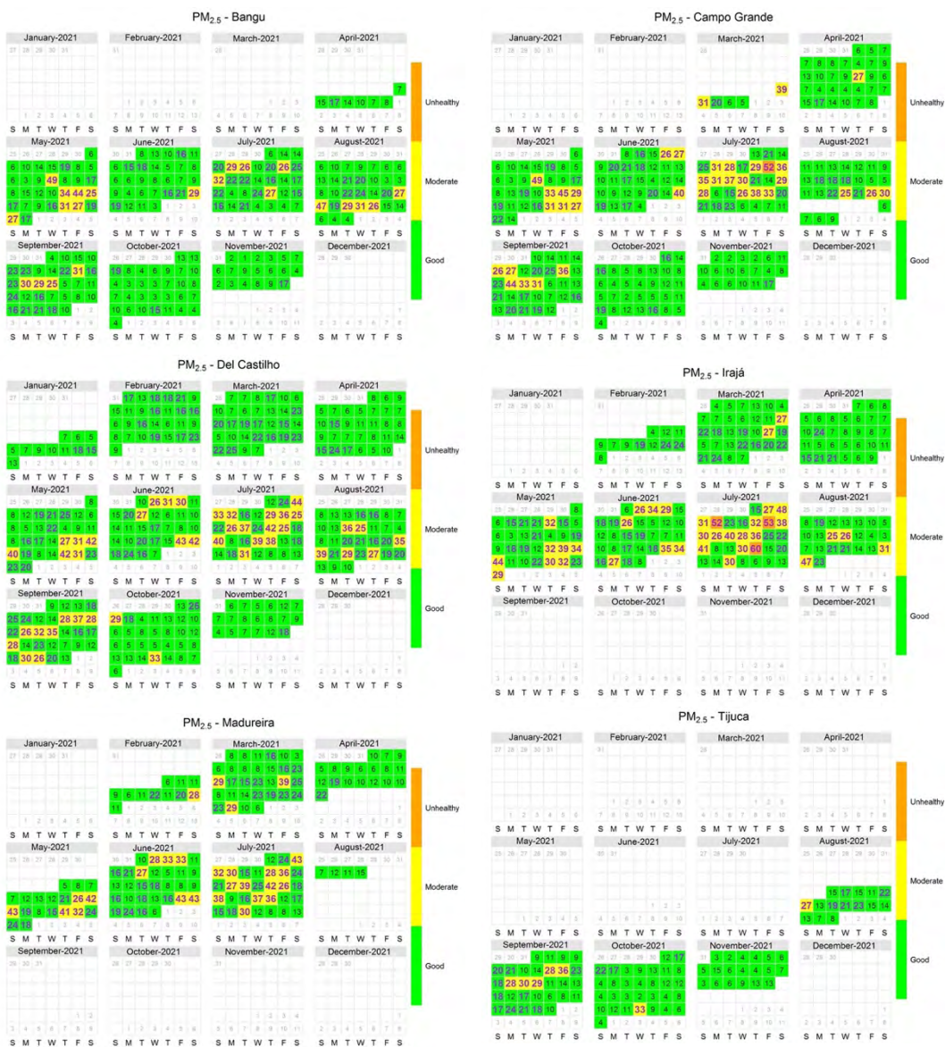
Figura 3 – IQA calculados para MP 2,5 considerando a legislação brasileira: “boa” (verde), “moderada” (amarela) e “ruim” (laranja). Os números indicados correspondem as concentrações médias para 24 horas em unidades de µg m -3 . As concentrações > 15 µg m -3 são indicadas em negrito.
