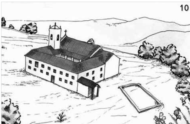
Figuras 8, 9, 10 e 11. Terceiro momento de ocupação do espaço pelos jesuítas (presença das alas da residência, que passam a abrigar a sacristia que existia na lateral, e a presença da cozinha na fachada posterior). Observar na Figura 11 a representação das fundações da nova cadeia ao lado da ala da fachada. Desenho: Gabriel Albuquerque.
