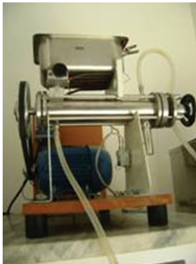
Figura 3. Cristalizador piloto para fondant .
