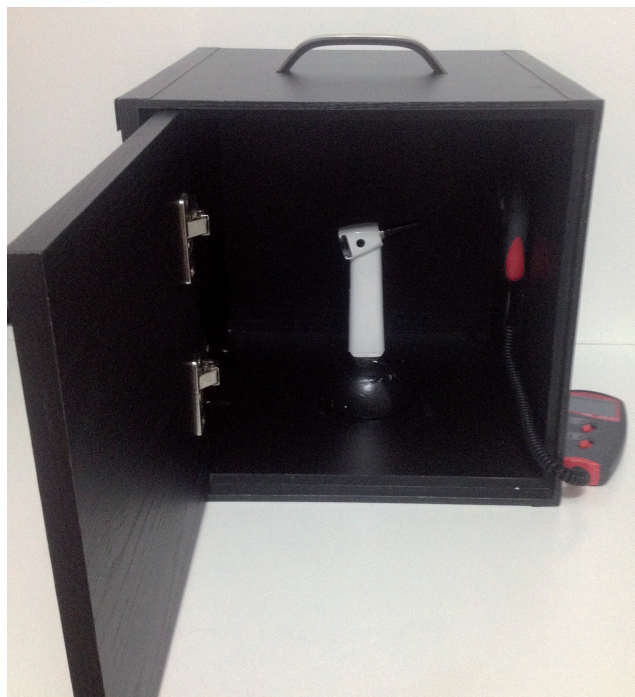
Figura 2 Otoscópio fixado em base com distância de 4 cm e luz direcionada ao ponto central do fotômetro.
