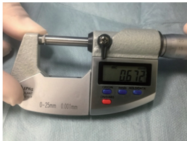
Figura 1 A mensuração da espessura da cartilagem tragal com o uso de um micrômetro.
