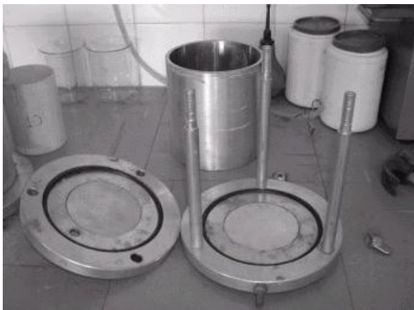
FIGURA 3 – Permeâmetro de carga variável da SOLOTEST.
