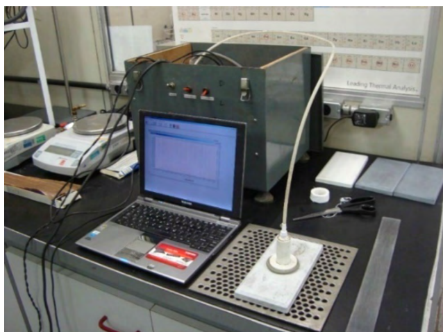
Figura 2: Imagem do ensaio de permeabilidade ao ar em peça com pigmento preto (0,05%).
