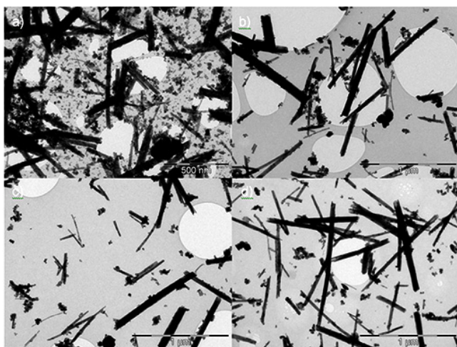
Figura 2: Micrografias de microscopia eletrônica de transmissão de nanofitas de Ce_{0,8}Gd_{0,2}O_{1,9-\delta} processada em a) 2 min, b) 4 min, c) 8 min e d) 16 min.
