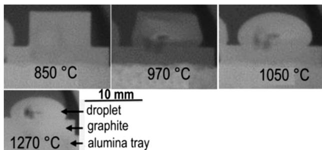
Figure 5: Matte-L droplet on graphite-substrate (850 °C to 1270 °C). [Figura 5: Gota de Matte-L no substrato de grafite (850 °C a 1270 °C).]
