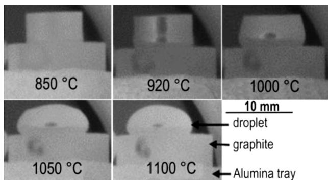
Figure 4: Matte-S droplet on graphite-substrate (850 °C to 1100 °C). [Figura 4: Gota de Matte-S no substrato de grafite (850 °C a 1100 °C).]
