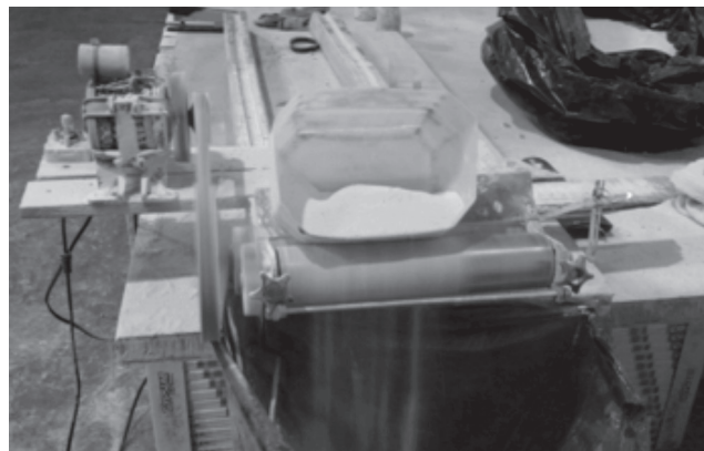
Figura 1: Trituramento eletromecânico para redução do tamanho das partículas.
