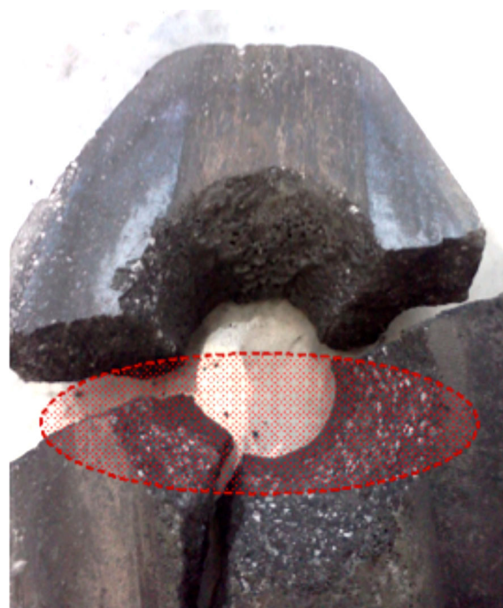
Figura 8: Placa BF com desgaste severo após uma corrida. Em destaque região retirada da placa para análise.
