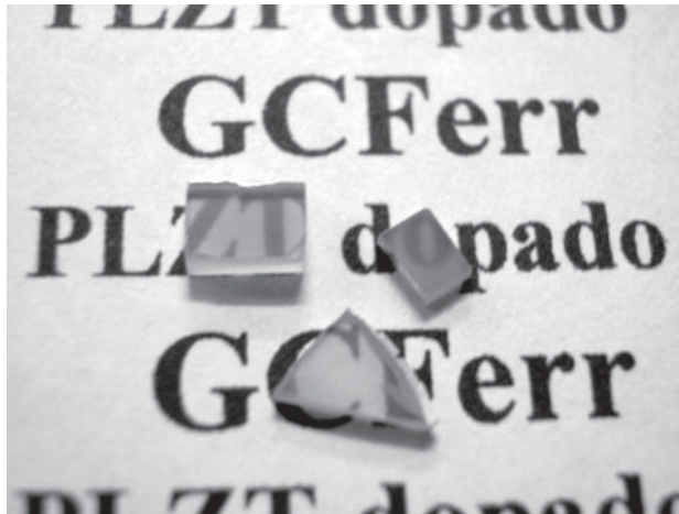
Figura 4: Fotografia de amostras de PLZT dopado com íons terras raras, prensadas uniaxialmente a quente.
