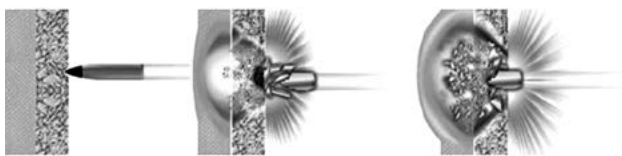
Figura 1: Esquema de blindagem mista: (a) antes; (b) ao longo e (c) depois de impacto balístico.
