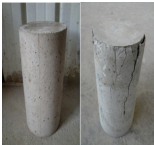
Figure 1: Cylinder 16 cm x 32 cm before and after test. [Figura 1: Cilindro de 16 cm x 32 cm antes e depois do teste.]
