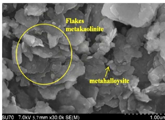
Figure 5: Micrograph obtained by SEM (secondary electrons) of clay brick waste B (after firing). [Figura 5: Micrografia obtida por MEV (elétrons secundários) do resíduo de tijolo B (após queima).]
