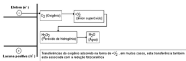
Figura 11: Mecanismo de redução. Fonte: Adaptado [33, 34].
