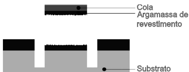
Figura 6: Desenho esquemático do modo de ruptura das argamassas no ensaio de resistência de aderência à tração.
