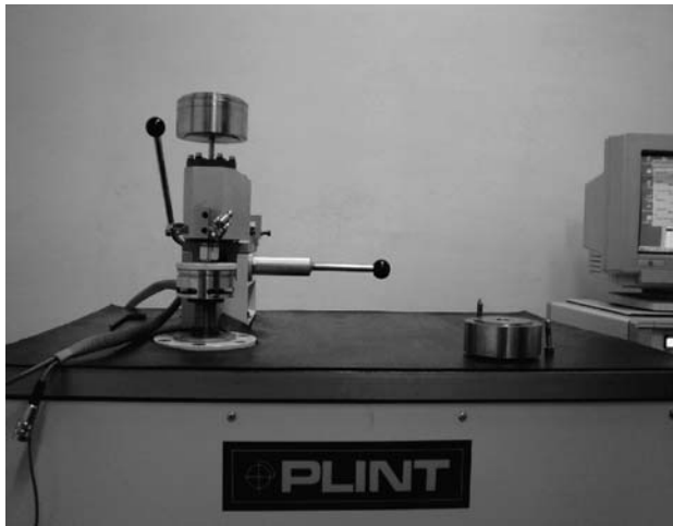
Figura 1: Equipamento de ensaio de resistência ao desgaste, do tipo pino-contra-disco.
