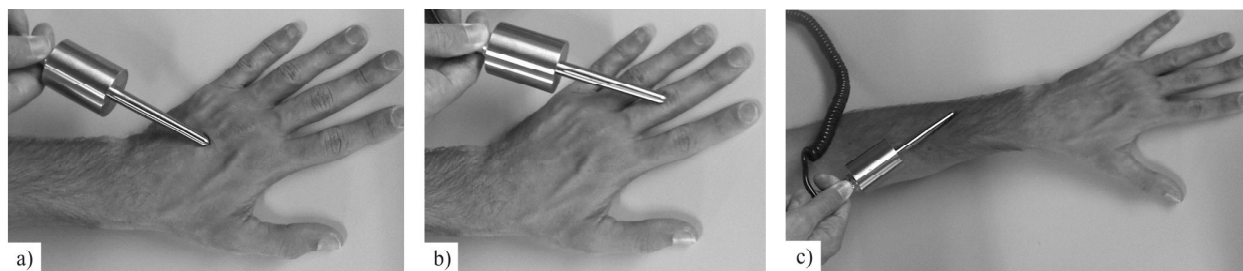
Figura 2 – Coordenadas ortogonais ISO 5349-1 (A: eixo xx; B: eixo yy e C: eixo zz).
