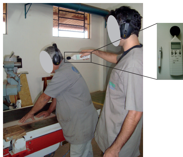
FIGURA 1 Medição do nível de pressão sonora com decibelímetro.
