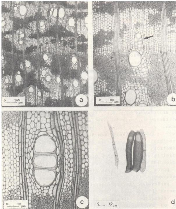
FIGURA 2: Fotomicrografia da madeira. A. Secção transversal, estacando a porosidade difusa e arranjo do parênquima axial. B. Secção transversal em limite de anel de crescimento, mostrando agrupamento característico de poros no lenho tardio (seta). C. Poros em agrupamento radial, com parênquima paratraqueal adjacente. D. Elementos vasculares de lenho tardio, com placa de perfuração simples, e série de parênquima adjacente.
