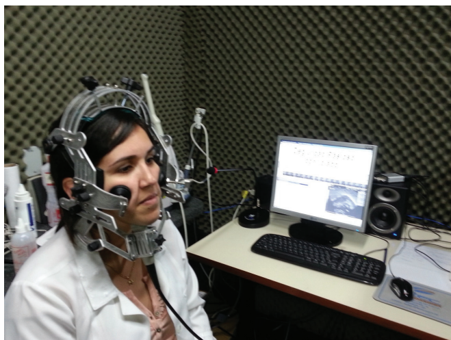
Figura 1. Coleta de dados: indivíduo sentado utilizando o estabilizador de cabeça com o transdutor do ultrassom acoplado na região submandibular
