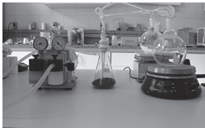
Figura 4. Sistema de extração e coleta dos voláteis de abacaxi montado no Laboratório.
