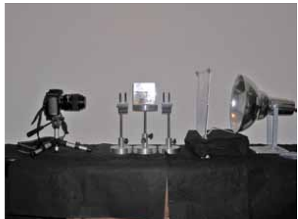
FIGURA 1 - Polariscópio circular utilizado no experimento (Eikonol Instrumentos Ópticos, São Paulo, Brasil).
