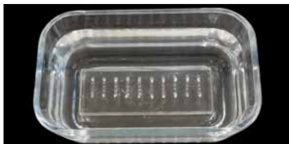
FIGURA 4 - Placa de resina acrílica submersa em saliva artificial.
