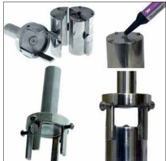
FIGURA 2 - Dispositivo de colagem usado para garantir a padronização. Exemplificação do processo de colagem do braquete ao disco de resina acrílica.
