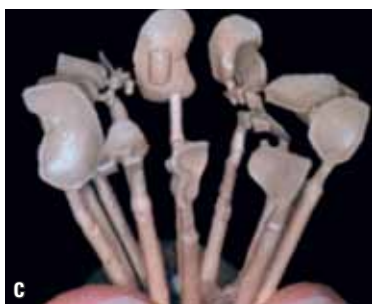
FIGURA 12 - Processo de fundição dos braquetes.
