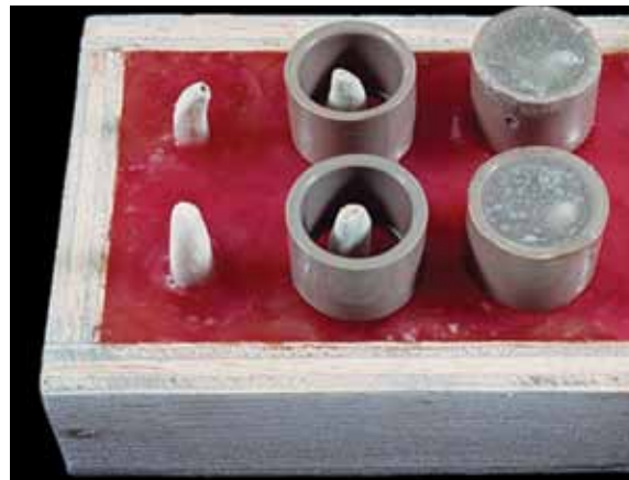
FIGURA 1 - Passos da inclusão do dente bovino no tubo de PVC.
