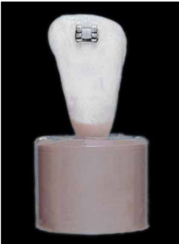
FIGURA 5 - Corpo de prova com braquete colado na superfície vestibular.
