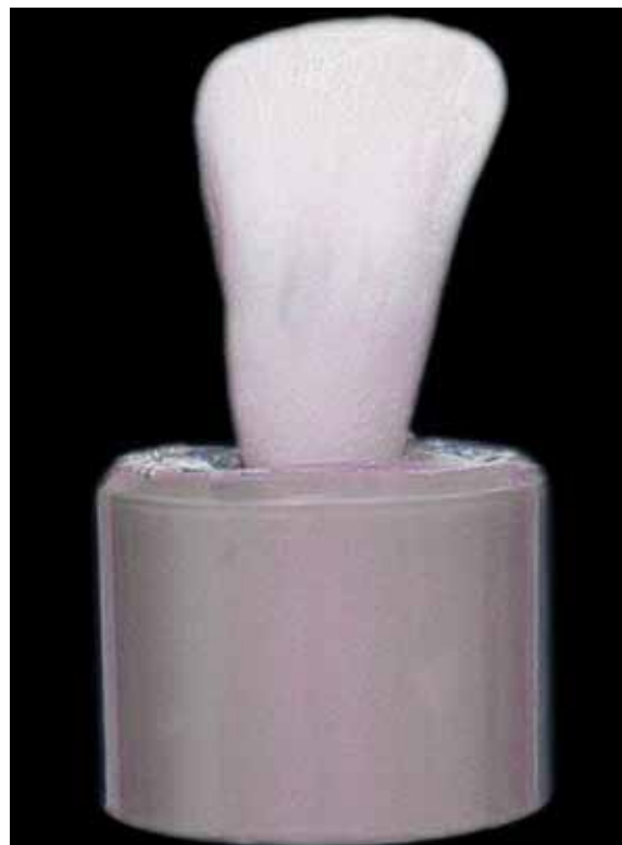
FIGURA 2 - Dente bovino inserido no tubo de PVC.
