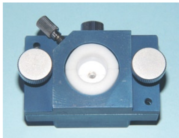
FIGURA 2 - Dispositivo utilizado para a confecção dos corpos-de-prova.
