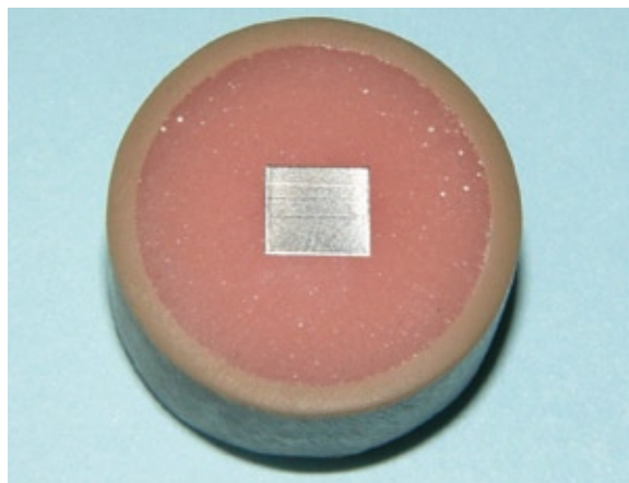
FIGURA 1 - Segmento de banda ortodôntica colado em resina acrílica incluída em tubo de PVC.
