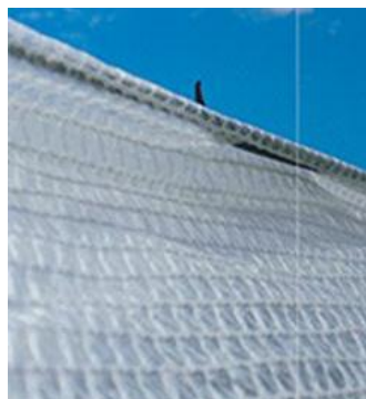
FIGURA 2: Filme de PEBD reforçado (Rio das Pedras-SP, 2011). Reinforced LDPE film.
