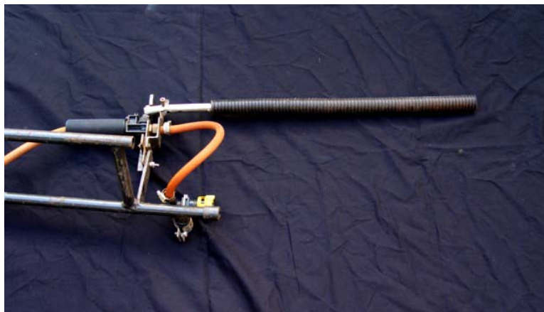
FIGURA 4. Dispositivo para aplicação “drench” intermitente. Device for intermittent drench application.
