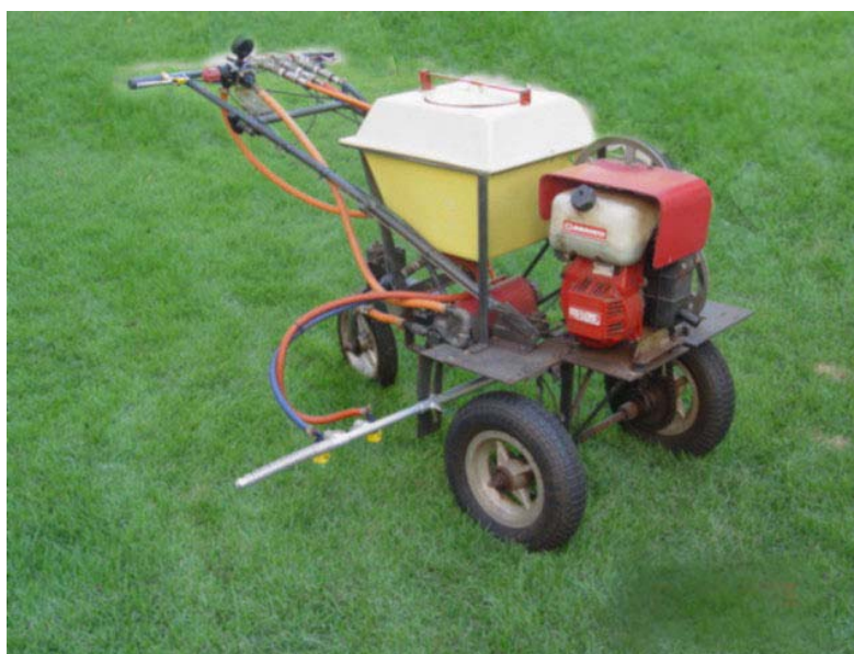
FIGURA 1. Protótipo desenvolvido para aplicação de produtos líquidos na cultura do café. Prototype developed for spraying coffee trees.
