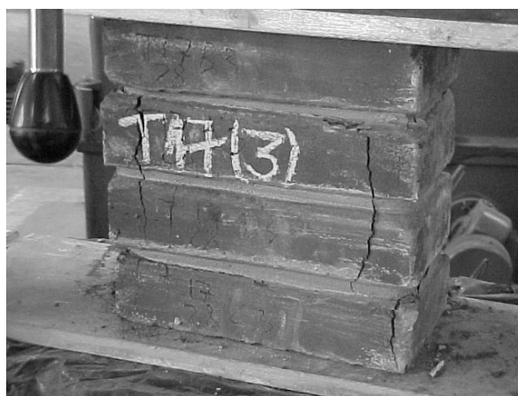
FIGURA 3. Fissuras verticais e horizontais nos minipainéis após a ruptura.
