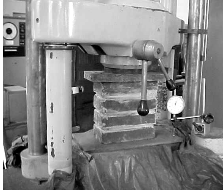
FIGURA 2. Minipainel submetido à compressão simples.
