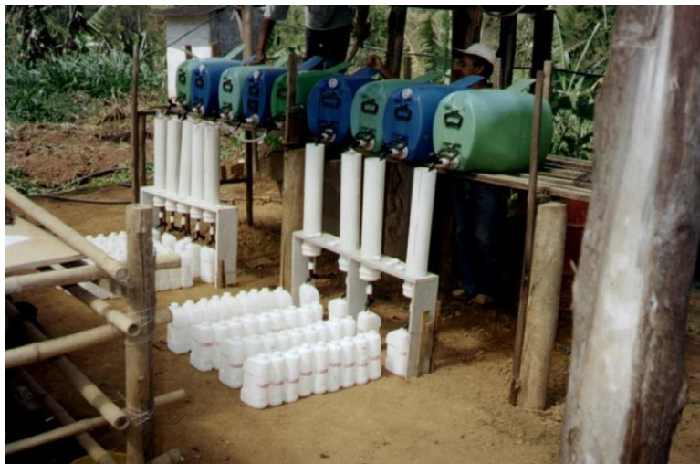
FIGURA 1. Detalhe da estrutura da bancada utilizada nos ensaios de filtração. Details of the structure of the bench used in filtration tests.
